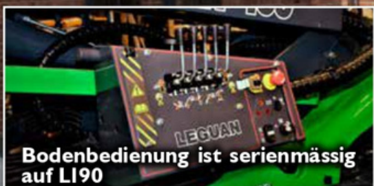
Bedienpult am Arbeitskorb mit automatischer Abstütznivellierung und Fahrantrieb mit automatischer Kraftübertragung, max. Fahrgeschwindigkeit 5.2 km/h
