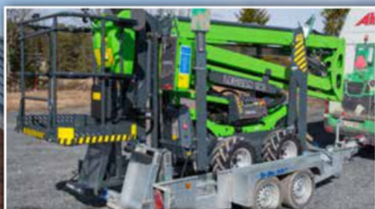
Neuer Sonderanhänger für Transport der LI90, zulässige Achslast 3500 kg
